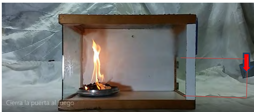
Incendio con puerta abierta
